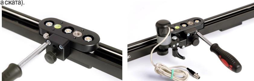
При использовании электропривода помните о необходимости разблокировки стояночного тормоза [1] с установленным на нем двигателем HDN-ZN-2. Разблокируйте пластину и прижмите валик к направляющей слайдера. Если вы хотите осуществить видеосъемку без использования электропривода, поднимите и зафиксируйте пластинку с роликом [2]. В этом положении каретка будет перемещаться свободно.
