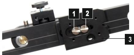
Прикрепить базу площадки Slide Kamera AKC-3 к гнезду штатива HST-2 или HST-3 с помощью монтажного винта HSZ-2 или полусферы Manfrotto 520Ball. Полусфера позволяет выровнять площадку на штативе. После этого можно вставить пластинку AK-101 в базу площадки и зафиксировать винты. Слайдер установлен.
