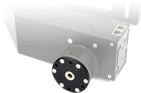
В основании головы имеется разъем с резьбой 3/8", с помощью которого голова может быть установлена на операторский кран, штатив или слайдер и 4-ре отверстия диаметром 4,2 мм (конфигурация Manfrotto), которые позволяют устанавливать голову X-HEAD непосредственно на полусферы SlideKamera 75/100 мм, имеющие четыре отверстия M4.
