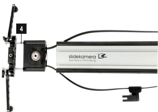
Вставьте крепежные винты M6x90 (4) в другие ножки слайдера, а затем в отверстия другой приводной головки (2). Приложите головку к шине слайдера под небольшим углом таким образом, что бы нижняя кромка головки соприкасалась с нижней кромкой шины слайдера. Выровняйте головку относительно шины слайдера, что бы отверстия шины слайдера и головки совпали, и прикрутите винты M6x90 к шине слайдера.
